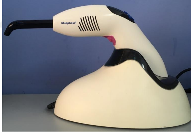
Şekil 2.12. Rezin siman örneklerin polimerizasyonu için kullanılan LED ışık cihazı
