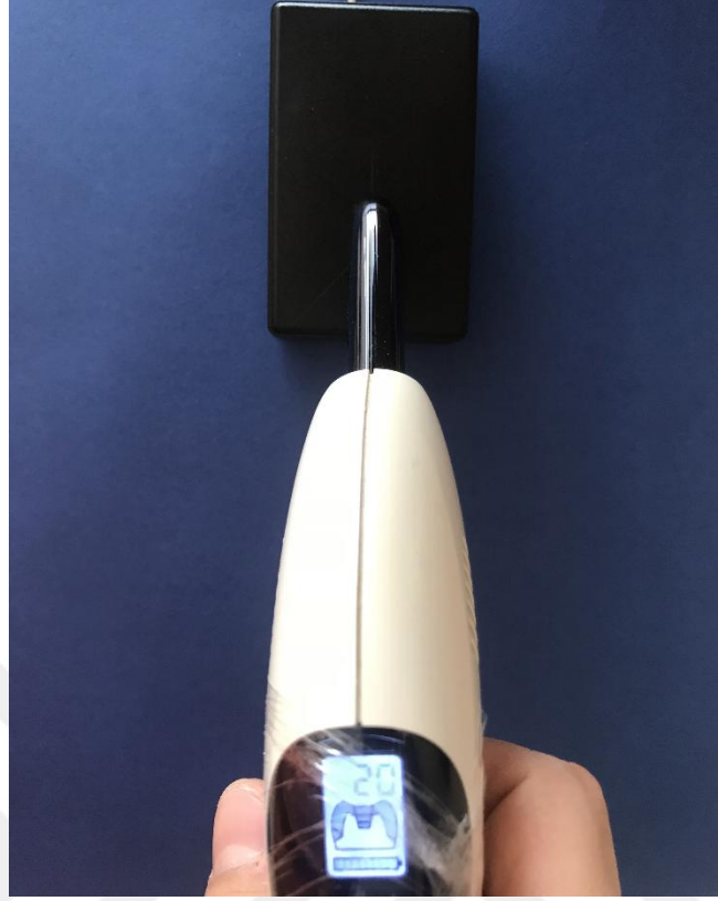
Şekil 2.13. Örneklerin LED ışık cihazı ile 20 sn polimerizasyonu
