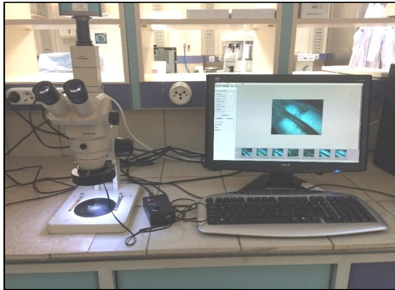
Şekil 2.7.1. Stereomikroskop cihazı (SZ- PT Olympus, Tokyo, Japonya)
