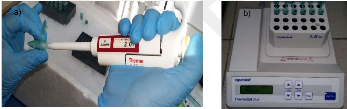
Şekil 2.16. a) EtOH-DEPC dH 2 O karışımının toplanması. b) Heat block cihazında ısı ile muamele edilmesi
