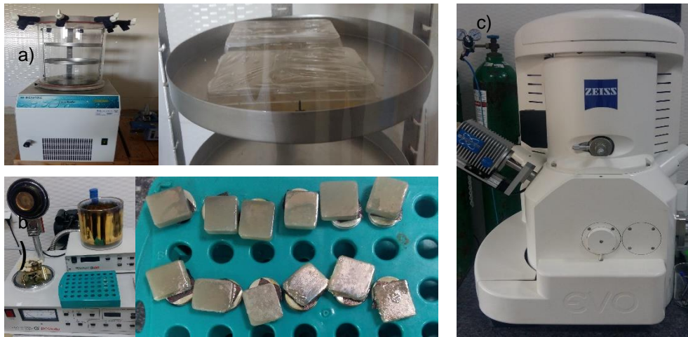
Şekil 2.23. a) Örneklerin liyofizitör cihazında kurutulması. b) Örneklerin altın yüzey kaplaması. c) SEM cihazı.
