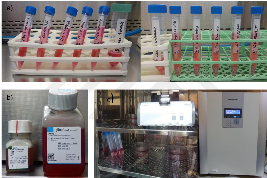
Şekil 2.3. a) Materyallerin DMEM içerisinde 3 ve 10 gün bekletilmesi. b) Fetal bovine serum, DMEM. c) Materyallerin İnkübatörde Bekletilmesi
