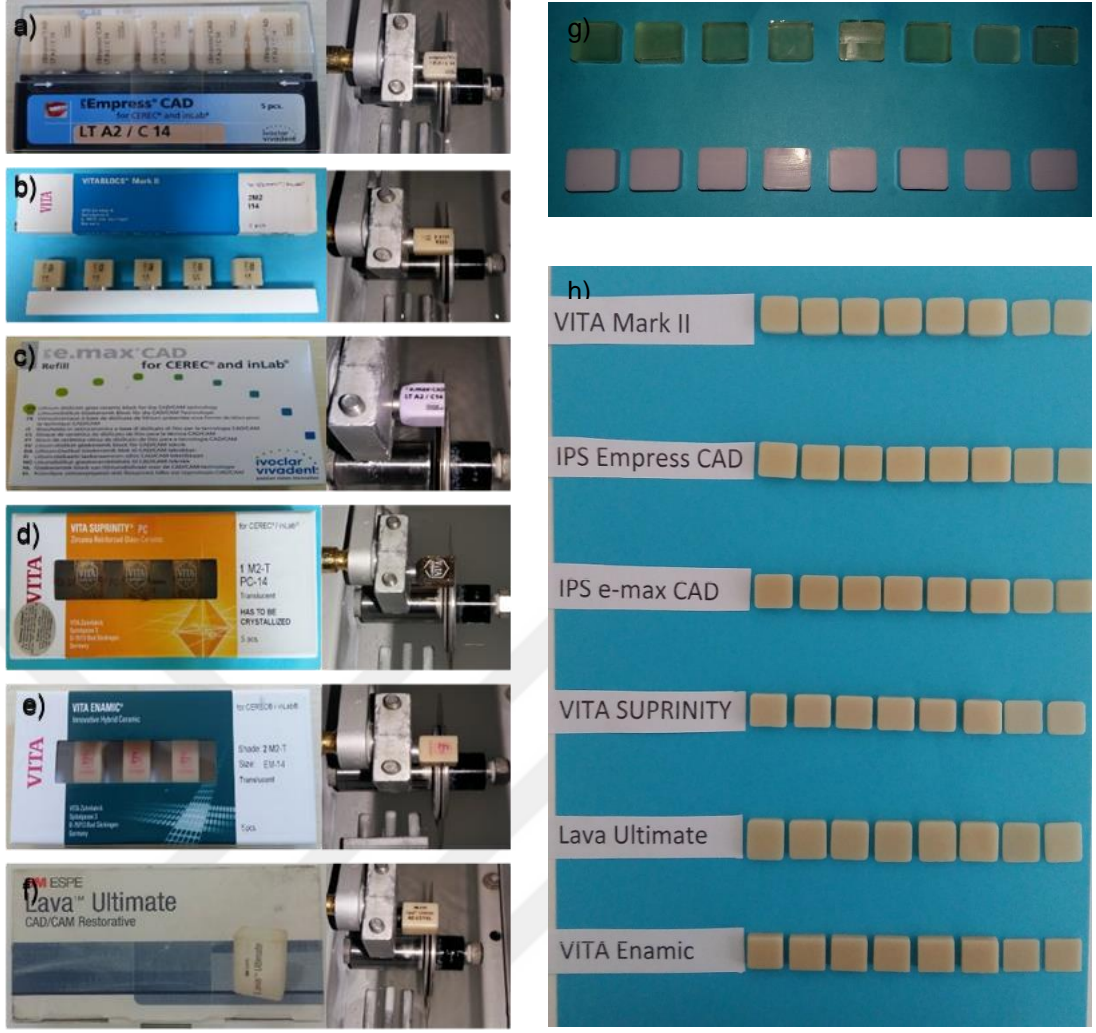
Şekil 2.1. a) IPS Empress CAD Örnekler. b) Vita Mark II Örnekler. c) IPS e.max CAD Örnekler. d) Vita Suprinity Örnekler. e) Vita Enamic Örnekler. f) Lava Ultimate Örnekler. g) Sinterizasyon öncesi Vita Suprinity ve IPS e.max CAD örnekler. h) CAD-CAM tam seramik örnekler
