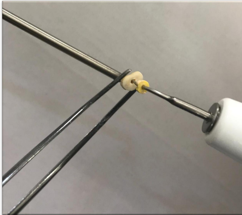
Şekil 2.5. Prepare edilmiş dişe ısıtılmış plugger temas ettirilirken dişin apikalinden termokupl ile sıcaklık ölçülmesi
