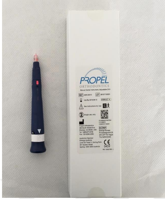
Şekil 2. 3. Propel cihazı ve istenen derinliğe ayarlandığını gösteren LED gösterge
