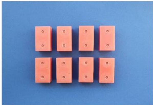
Şekil 2.25. Locator matrisi içeren akrilik bloklar.
