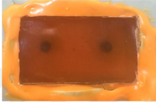
Şekil 2.16. Elastomerik ölçü içerisine dökülmüş PL-2 fotoelastik rezin.
