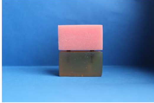
Şekil 2.37. Dolder bar klips yerleştirilmiş akrilik blok ve fotoelastik rezin blok.
