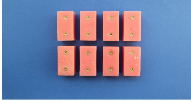
Şekil 2.30. Novaloc matriks içeren akrilik bloklar.
