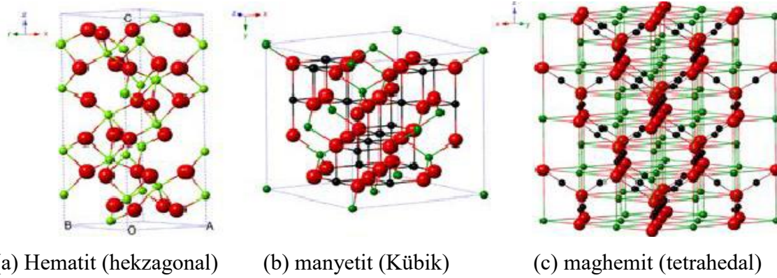
Şekil 2.3. (a) Hematit, (b) manyetit ve (c) maghemitin kristal yapısı ve kristalografik verileri (siyah top Fe^{2+} , yeşil top Fe^{3+} ve kırmızı top O^{2-} ) [31].
