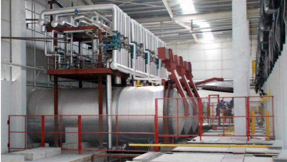
Resim 2.2 Alfa alçısının otoklavda üretimi (İnt.Kyn.8).
