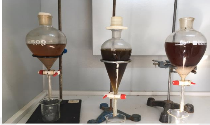
Resim 3.7 Deney sonucu oluşan sıvı fazların ayırma hunisi ile ayrılması.
