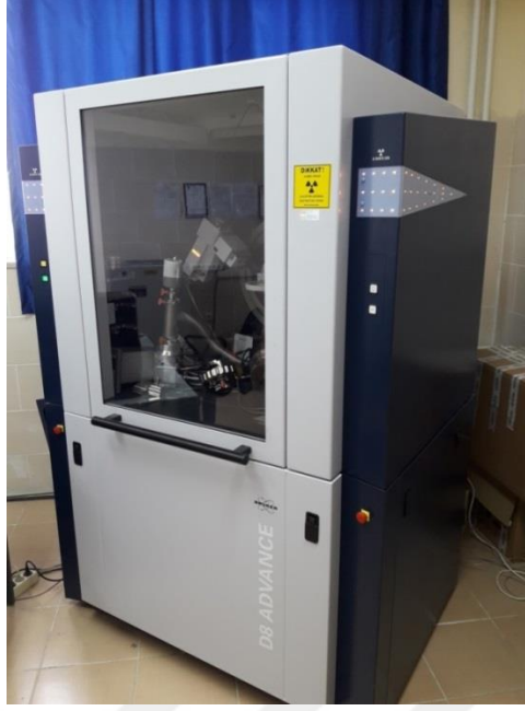
Resim 3.11 Bruker D8 Advance XRD cihazı.
