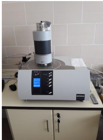
Resim 3.12 Netzsch STA 449 Jupiter DSC cihazı
