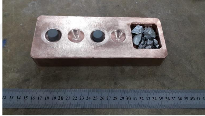
Resim 3.6 Ergitme öncesi master alaşımlar ve fedai alaşım.
