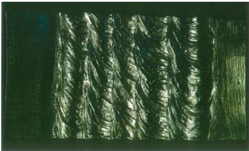
Resim 4.24 Korozyon Testi Sonrası Kapak(kep) Paso Görüntüsü.
