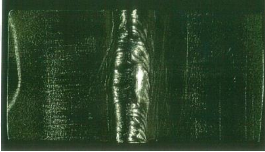
Resim 4.23 Korozyon Testi Sonrası Kök Paso Görüntüsü.
