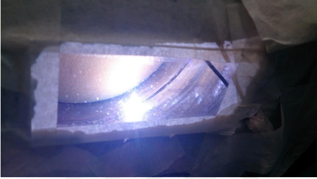
Resim 3.4 TIG Kaynak Yöntemi ile Yapılan Kök Pasonun Düzenek İçinden Görünümü.
