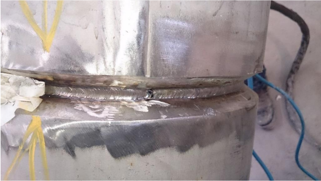
Resim 3.7 TIG Kaynak Yöntemi ile Yapılmış Kök Paso Görünümü.
