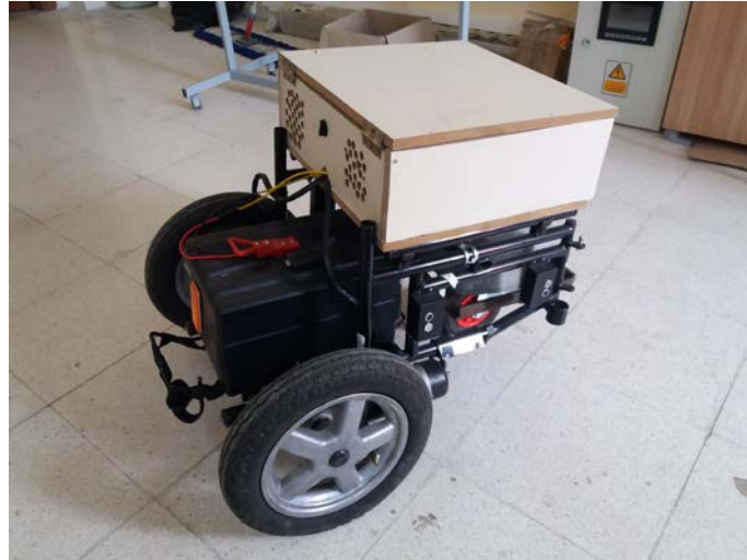
Resim 3.5 Tez kapsamında oluşturulan elektrikli araç.
