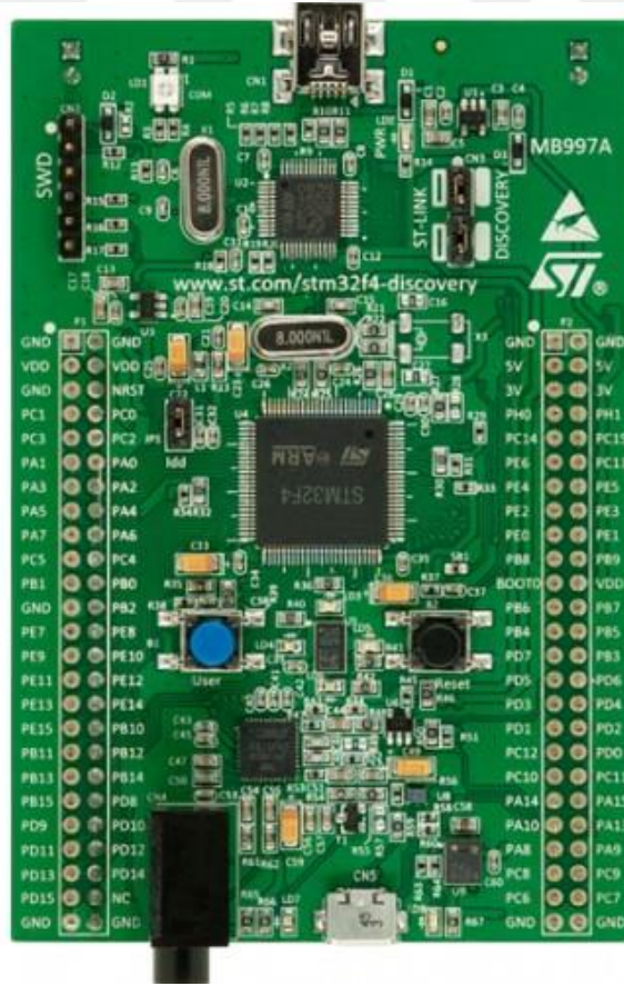
Resim 3.3 STM32F4 Discovery geliştirme kartının bir görüntüsü.
