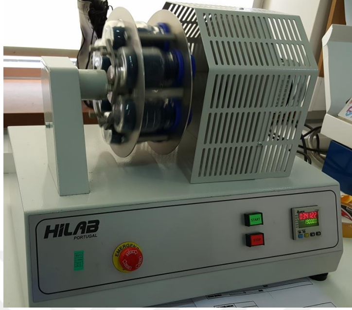
Resim 3.16 Kılıflarda su buharı geçirgenliği analizi.
