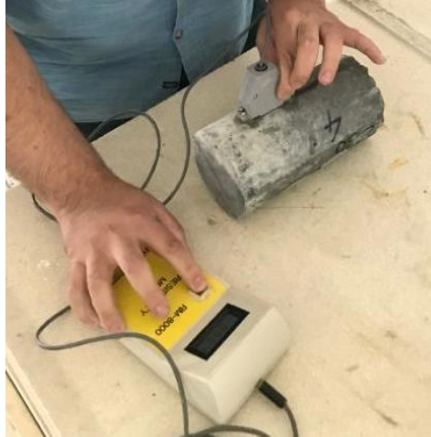
Resim 3.5 Elektriksel özdirenç ölçümü.
