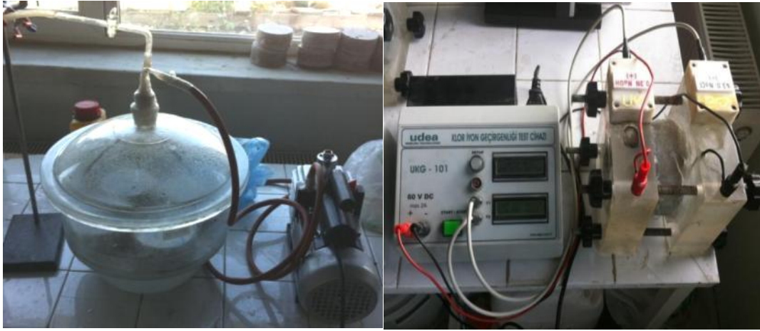
Resim 3.4 Vakum iřlemi ve hızlı klorür geçirirnililiđi deney dzeneđi.
