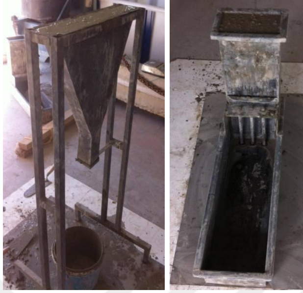
Resim 3.3 V hunisi ve L kutusu deneylerinin yapılışı.
