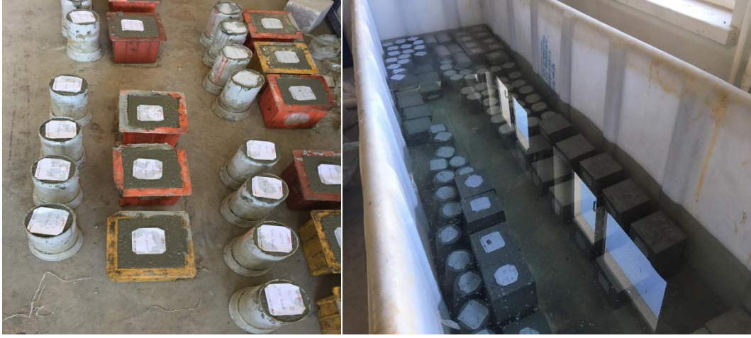
Resim 3.1 Kalıplarda bekletilen ve kür yapılan numuneler.
