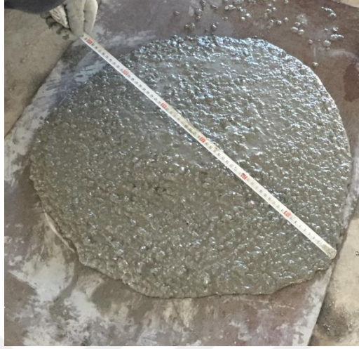
Resim 3.2 Yayılma çaplarının ölçümü.
