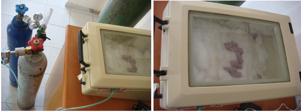
Şekil 3, 4: Hava geçirmez kapalı bir ortamda H/R yöntemi uygulanışı.
