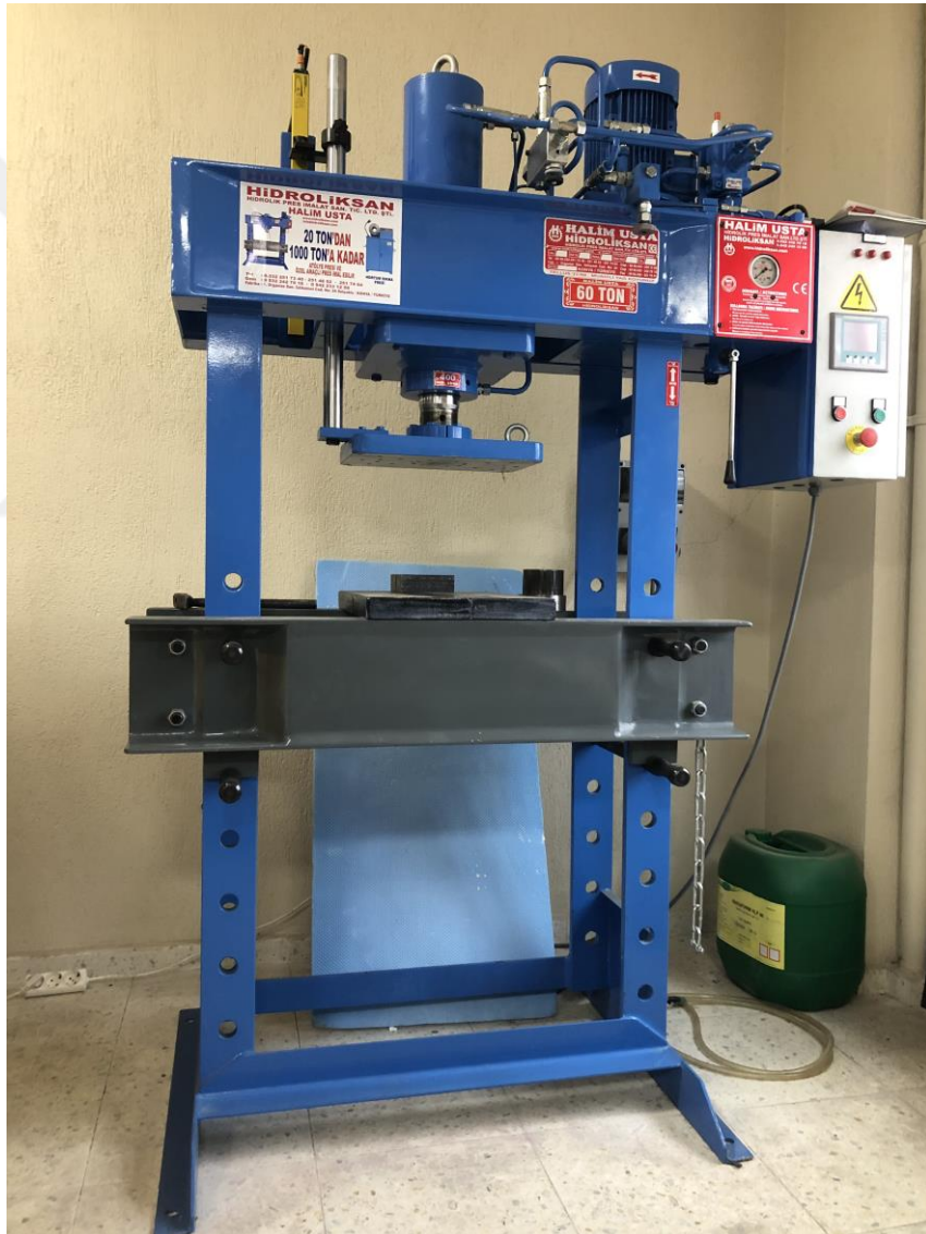
Şekil 3.7 Şekillendirme için kullanılan hidrolik pres.
