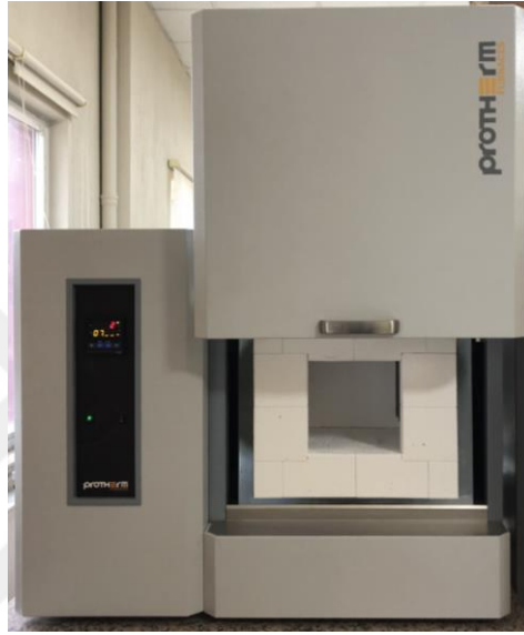
Şekil 3.8 Sinterleme için kullanılan yüksek sıcaklık fırını.
