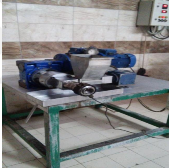
Resim 3.7 Yaban eriği, vişne ve kiraz çekirdek yağlarının elde edilmesinde kullanılan soğuk pres makine.
