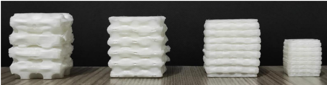
Resim 4.2 Dairesel ve duvar kalınlığı 1 mm olan numunelerin basma test sonrası görüntüleri.
