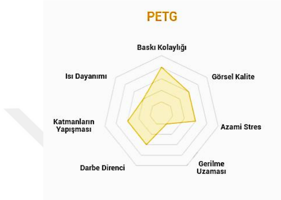
Şekil 2.6 PETG filamentinin özelliklerinin şekil üzerinde gösterimi (İnt.Kyn.4).
