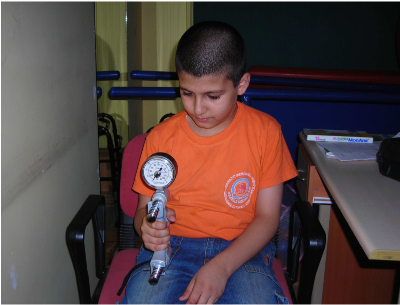
Şekil 3.11.1. Kavrama kuvvetinin Jamar el dinamometresi ile değerlendirilmesi
