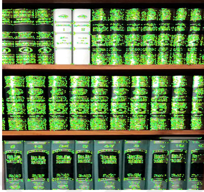
Resim 4.12 FPGA üzerinde fast köşe algılama algoritması ile ışık düzeyi yüksek ortamda görüntü üzerinde köşe bulunması.
