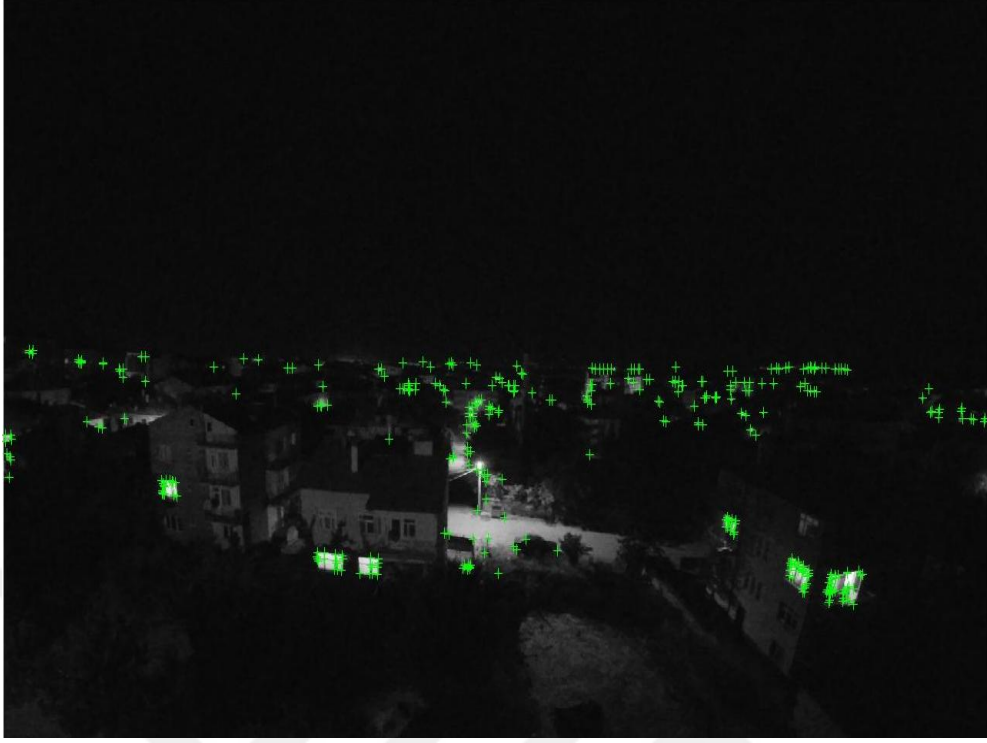
Resim 4.8 Matlab uygulamasında bulunan fast algoritması ile ve ışık düzeyi düşük ortamda köşe bulunması.
