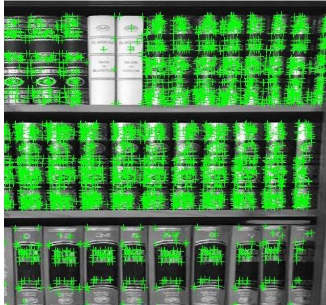
Resim 4.11 Matlab uygulamasında bulunan fast algoritması ile ve ışık düzeyi yüksek ortamda köşe bulunması.
