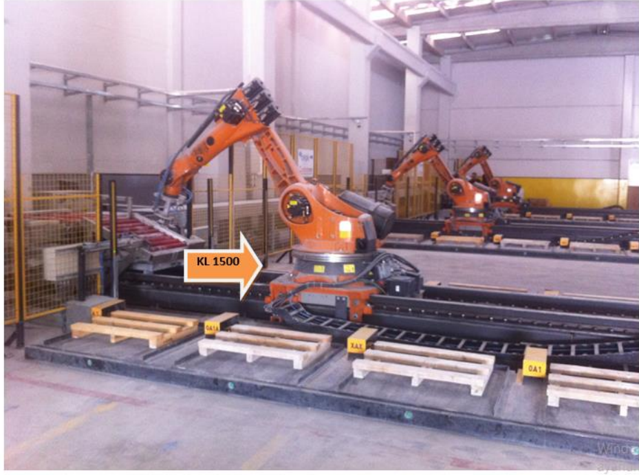
Resim 2.1 Manipülatöre montajı yapılmış track.
