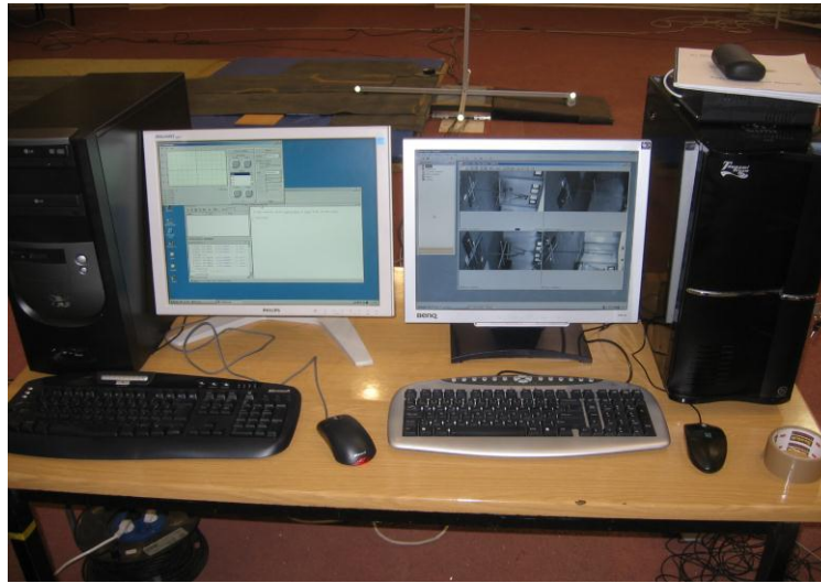
Resim 3.1. Deney düzeneğinde kullanılan hareket analizi sistemi (SIMI 7.5) ve kuvvet platformunun (FP4060-10, BERTEC, A.B.D.) bilgisayar üniteleri.
