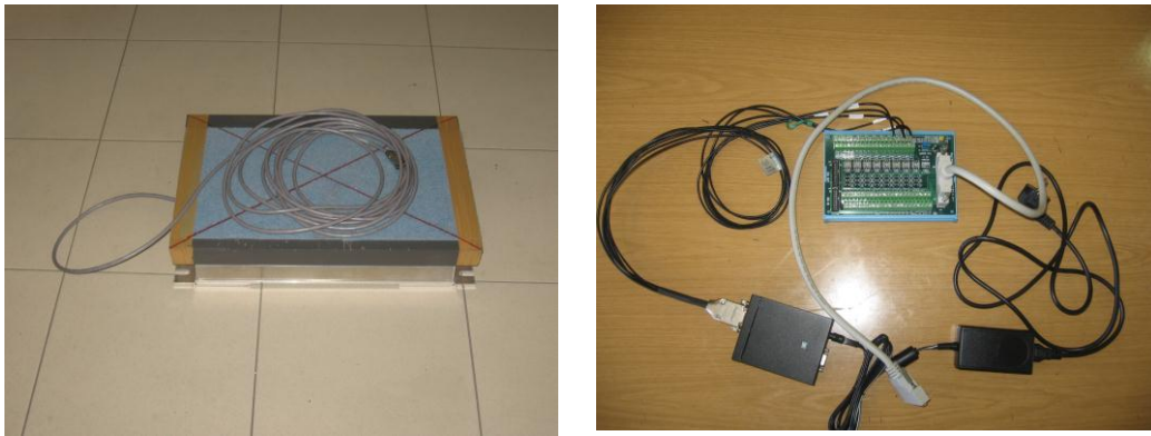
Resim 3.2. Kuvvet platformu ve analog güçlendirici.
