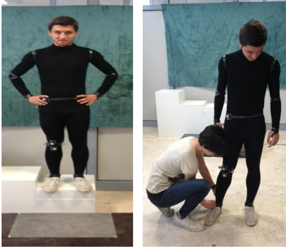
Resim 3.4 Denek üzerine yerleştirilen işaretçiler.
