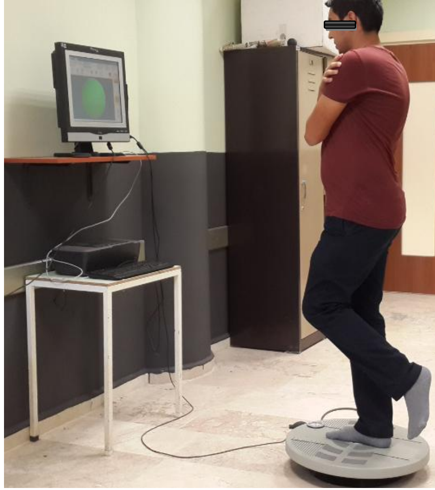
Resim 3.4.1.3.2. Portatif Bilgisayarlı Kinestetik Denge Cihazı (SportKAT 550)
