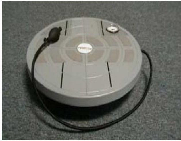
Resim 3.4.2.1.2.1. Sport-KAT 550 Baz Standı, El Pompası ve Analog Basınç Göstergesi ile Taşınabilir Bir Ünite
