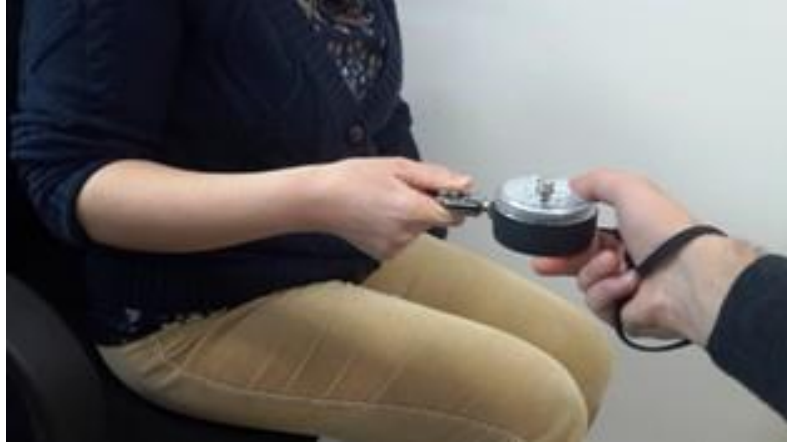
Şekil 4. Parmak dinamometrisi (Pinchmetre-Sammons Preston, USA)
