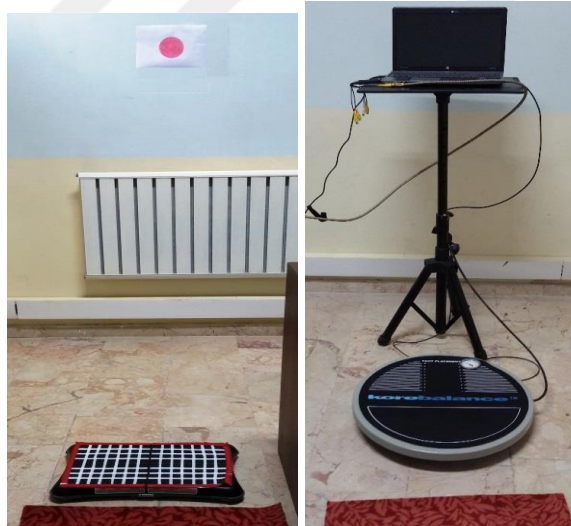
Şekil 3.8 NW ve KAT denge değerlendirme düzeneği
