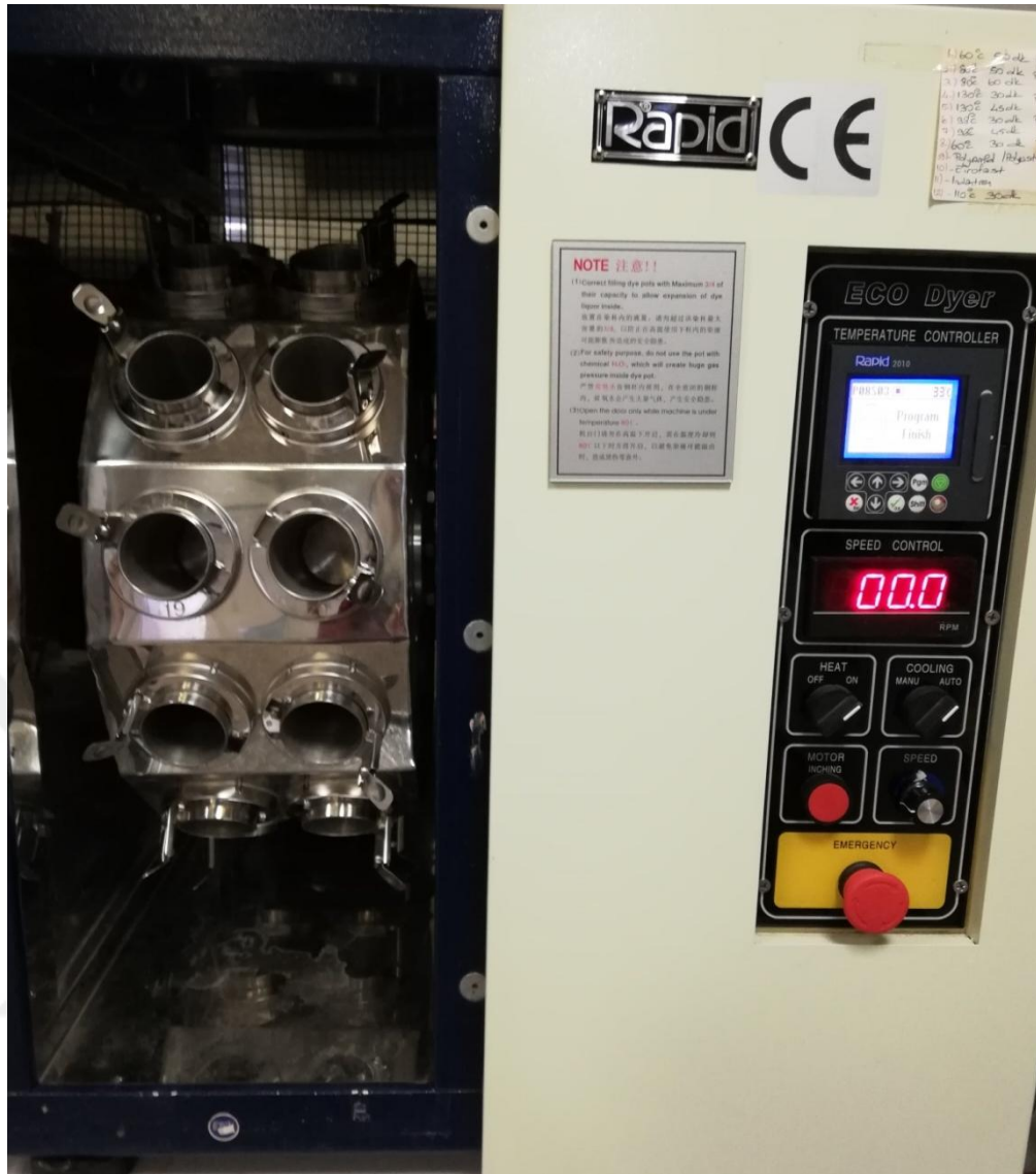
Şekil 3. 4. Rapid: EcoDyer laboratuvar tipi boyama makinesi
