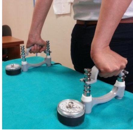
Resim3.5.2. Jamar®el dinamometresi ile Push Off Testi uygulaması
