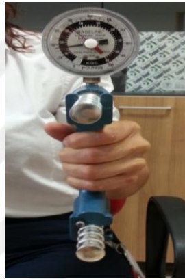
Resim 3.5.1. Baseline® dinamometre ile kavrama kuvveti ölçümü
