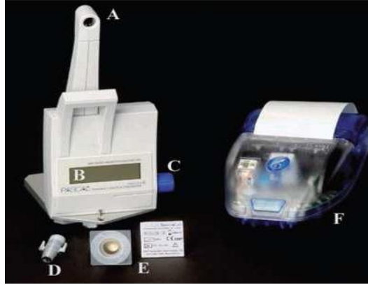
Şekil 3. Pascal dinamik kontur tonometresi A: DKT'nin sensör kolu, B: Elektronik görüntü ekranı, C: Kalibrasyon düğmesi, D: Sensör ucu, E: Sensör başlığı, F: Kablosuz yazıcı
