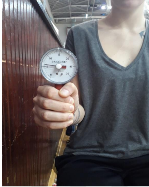
Resim 3.1.3.1. El kavrama hassasiyetinin ölçümü
