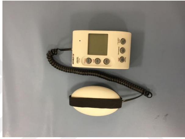
Şekil 1.1 Çalışmada kullanılan Power Track II Commander dinamometresi.
