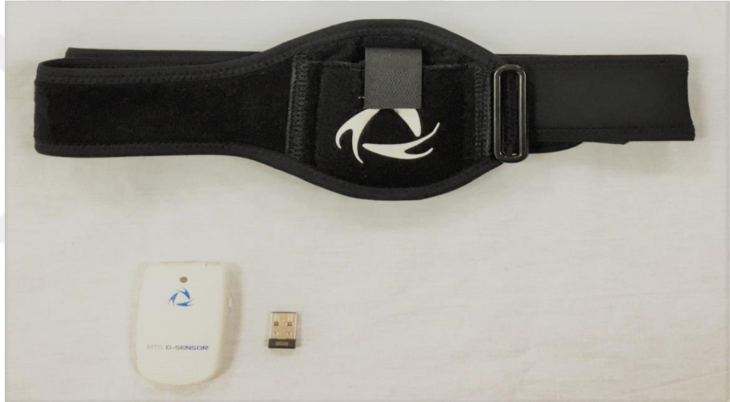
Şekil 3.7.1 BTS G-Walk Tempora-Spatial Yürüyüş Analiz Sistemi
