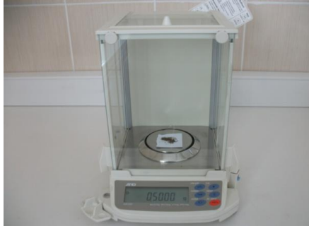
Şekil 3. 7. Hassas terazide toprak ölçümü.
