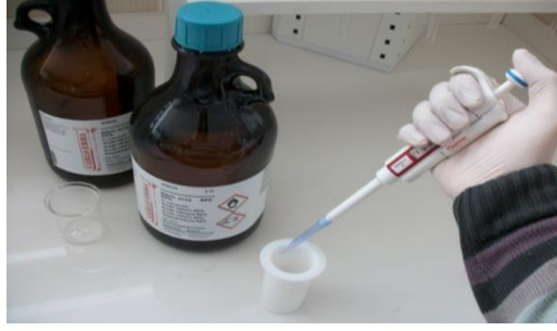
Şekil 3. 8. Teflon kaba asit eklenmesi.
