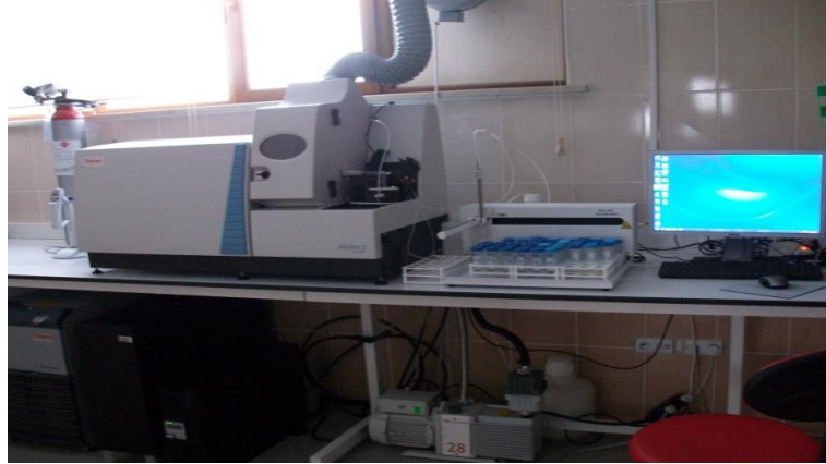
Şekil 3. 12. ICP – MS ile analizlerin yapılması.
