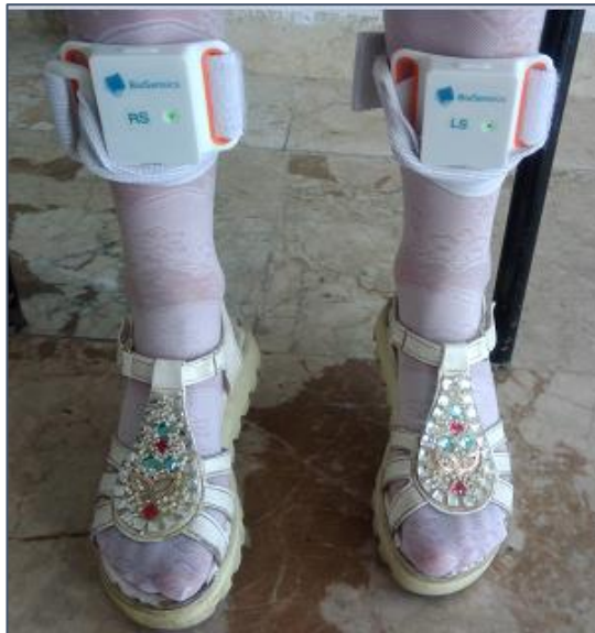
Şekil 3.10.2 LEGSys™ cihazının yerleşimi
