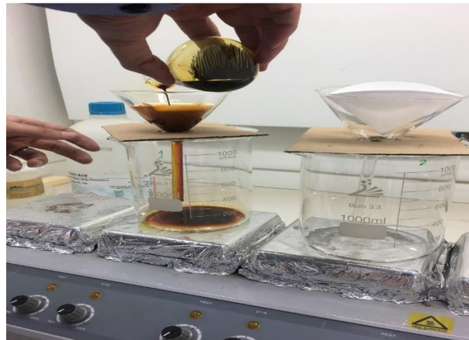
Şekil 3-24: Karıştırılan numunelerin 1000 ml behere süzülmesi
