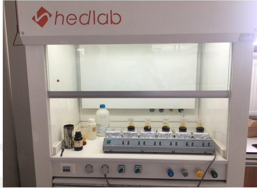
Şekil 3-23: Erlenlerdeki indirgenmiş numune ve bromin metanol çözeltisinin karıştırılması
