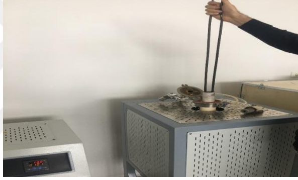
Şekil 3-12: Briket/yığıntının tüp fırında indirgenmesi
