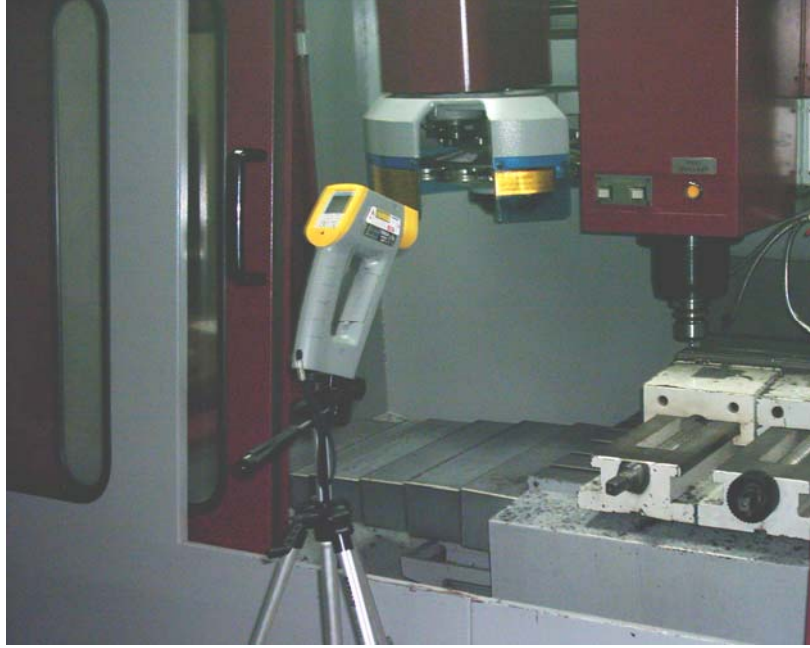
Şekil III. 13 Malzeme İşlenirken Yapılan Sıcaklık Ölçümü
