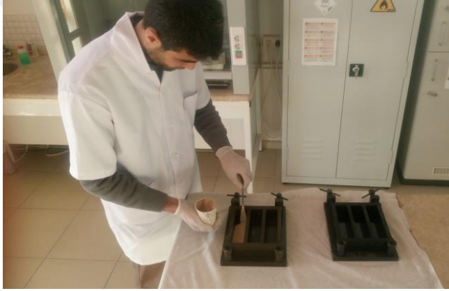
Figür 35: Onarım Harcının Kalıplara Dökülmesi
