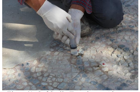
Figür 61: Saf Su ile Tessellatum Altının İslatılması
