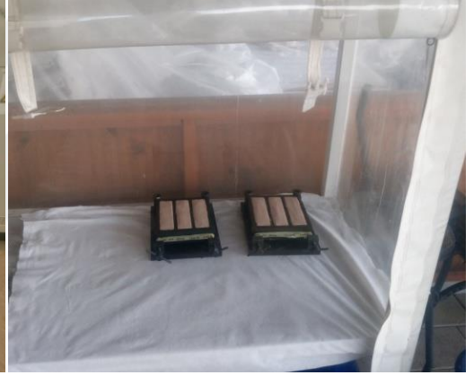
Figür 36: Onarım Harcının Kalıplara Dökülmüş Hali
