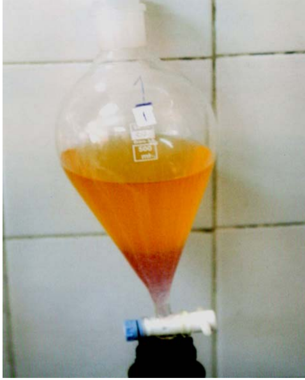
Şekil 6.5. Ayrırma Hunisinde Kurşun Analizi Yapılışı
