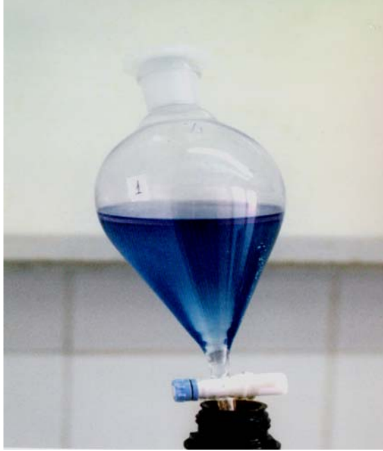
Şekil 6.4. Ayrma Hunisinde Deterjan Analizi Yapılışı
