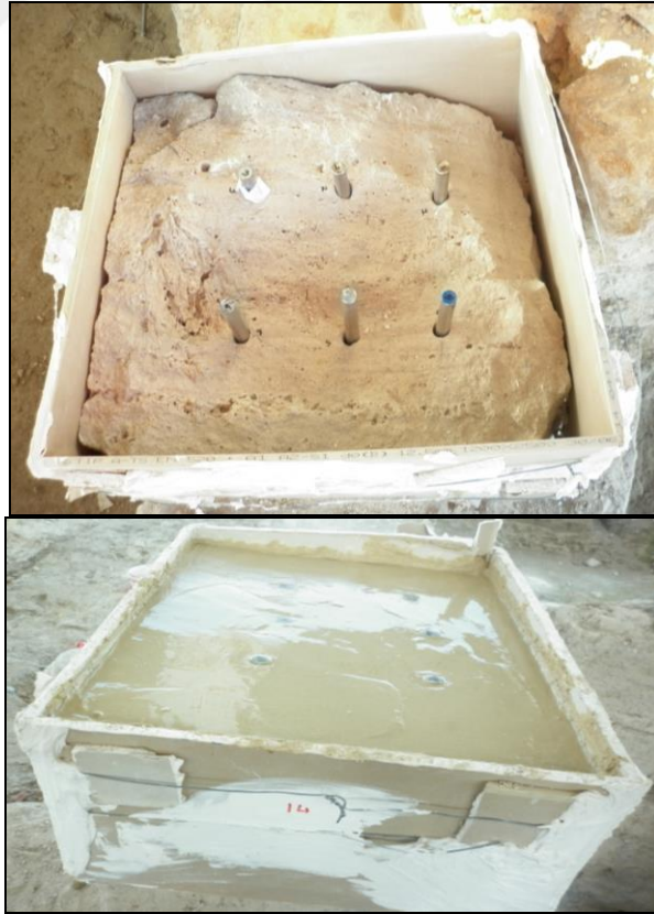
Fig. 60: Harç Karışımı Kalıplar Hazırlanarak Dökümünün Yapılması
