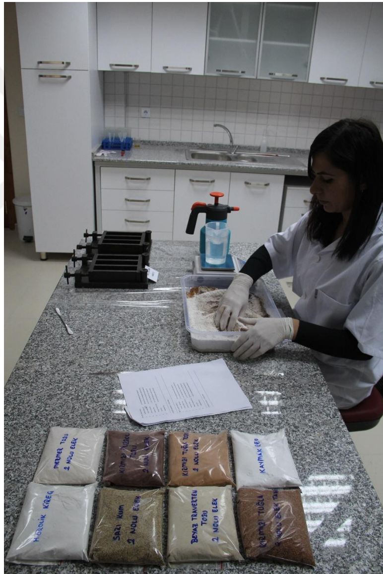
Resim 14a: Onarım Harcının Hazırlanması
