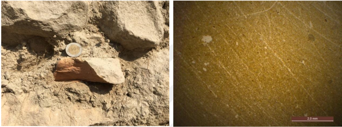
Figür 4.5 Tuğla örneğinin (TK4) makro ve mikro görüntüsü ve mikro görüntüdeki yönelmeler
