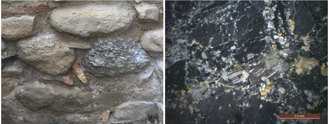
Figür 4.8 Gözlü gnays örneğinin makro ve mikro görüntüsü (TK6)
