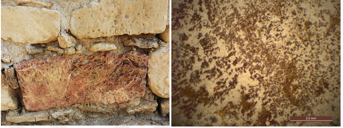
Figür 4.12 Kireçtaşı örneğinin (TK11) makro ve mikro görüntüsü
