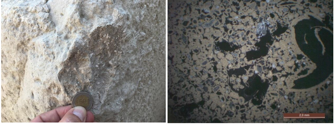
Figür 4.3. Kumtaşı örneğinin (TK3) makro ve mikro görüntüsü
