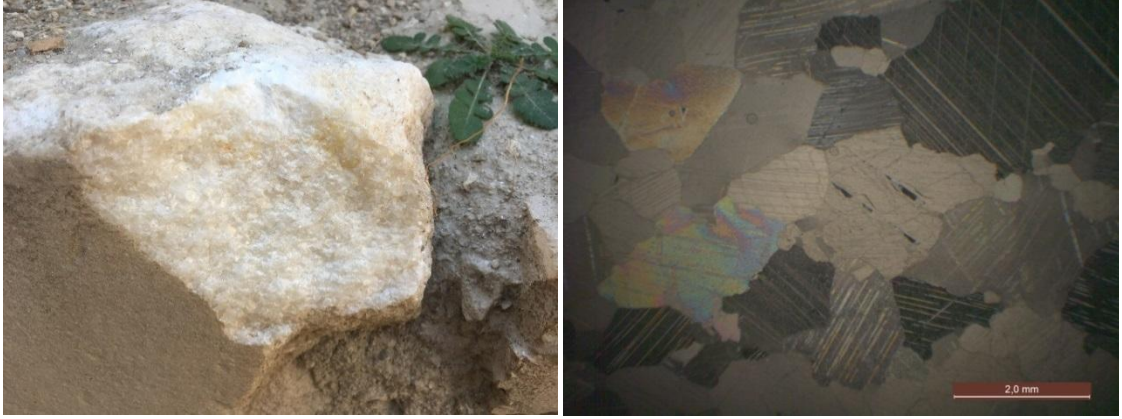
Figür 4.1. Mermer (TK1) örneğinin makro ve mikro görünümü
