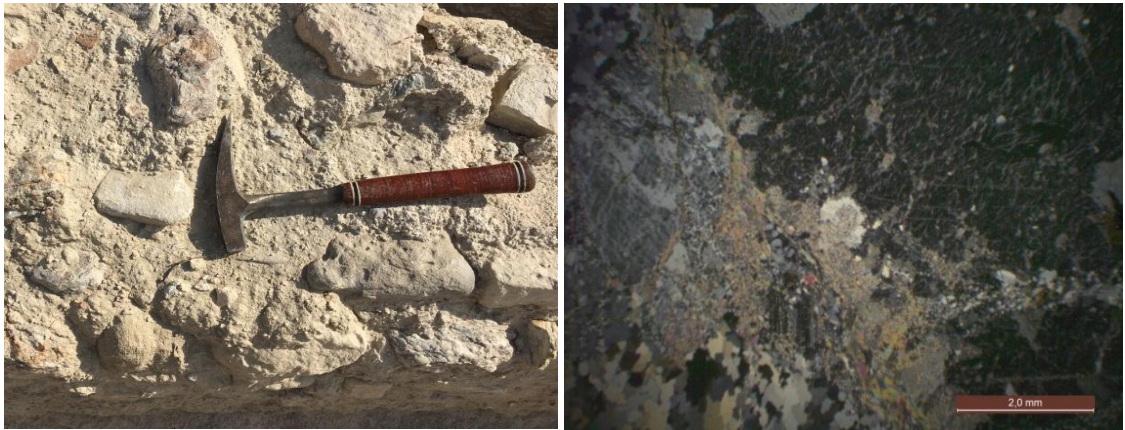
Figür 4.11 Şist örneđinin makro ve mikro görüntüsü (TK10)
