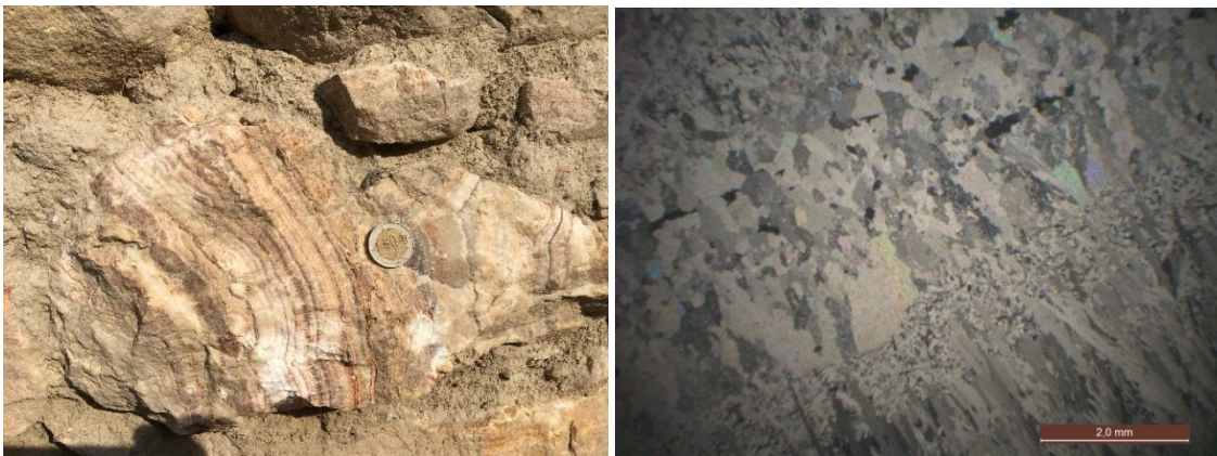
Figür 4.2. Bantlı Traverten (TK2) örneğinin makro ve mikro görünümü
