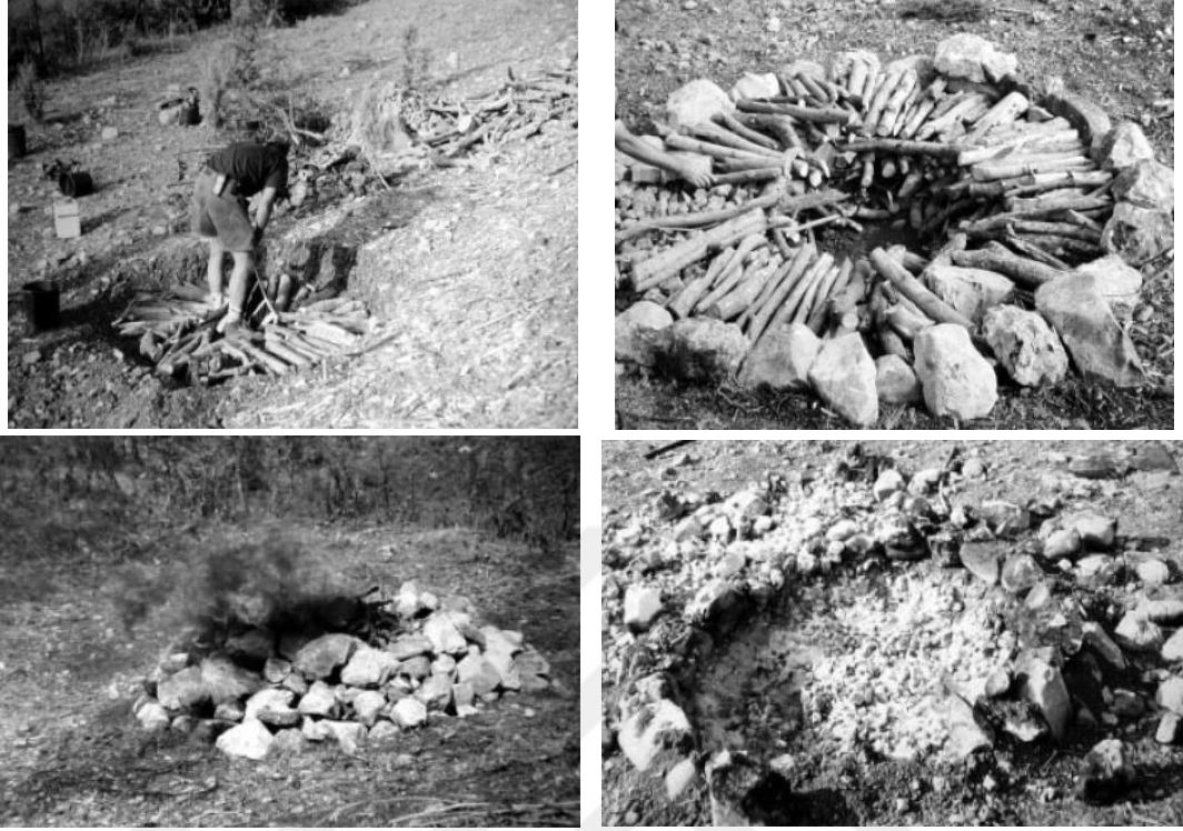
Figür 2: Deneysel Kireç Üretim Çalışmaları: Çukur İçi Ahşap ve Gübre ile Doldurulur (Sol Üst Köşe). Ateşleme İşlemi Sırasında Fırının Görünümü (Sol Alt Köşe). İşlem Sonrasında Toplanan Sönmemiş Kireç ile Oluşturulan Sıva Yüzeyi (Sağ Alt Köşe).
