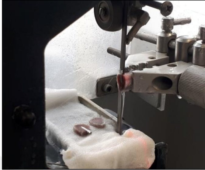
Şekil 3.6 Exakt Grinder cihazı ile örneklerin 2-3 mm'lik kesitler haline getirilmesi
