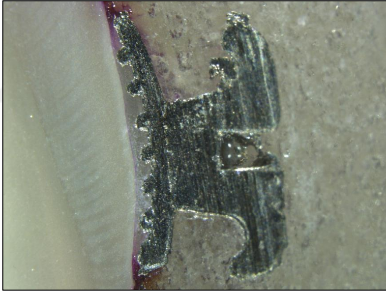
Şekil 4.8. Mikrosızıntı izlenen metal braketli örnek
