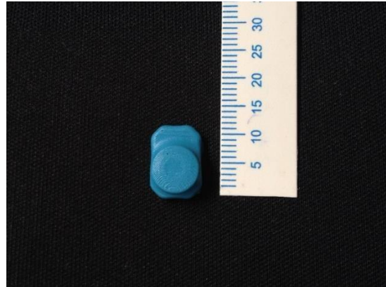
Şekil 3.3. Çalışmamızda kullanılan Theramon mikrosensör
