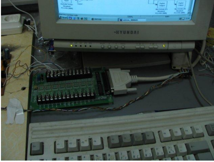
Şekil V-7 Dijital Analog Veri Giriş Çıkış Kartının Bağlantı Üniteleri
