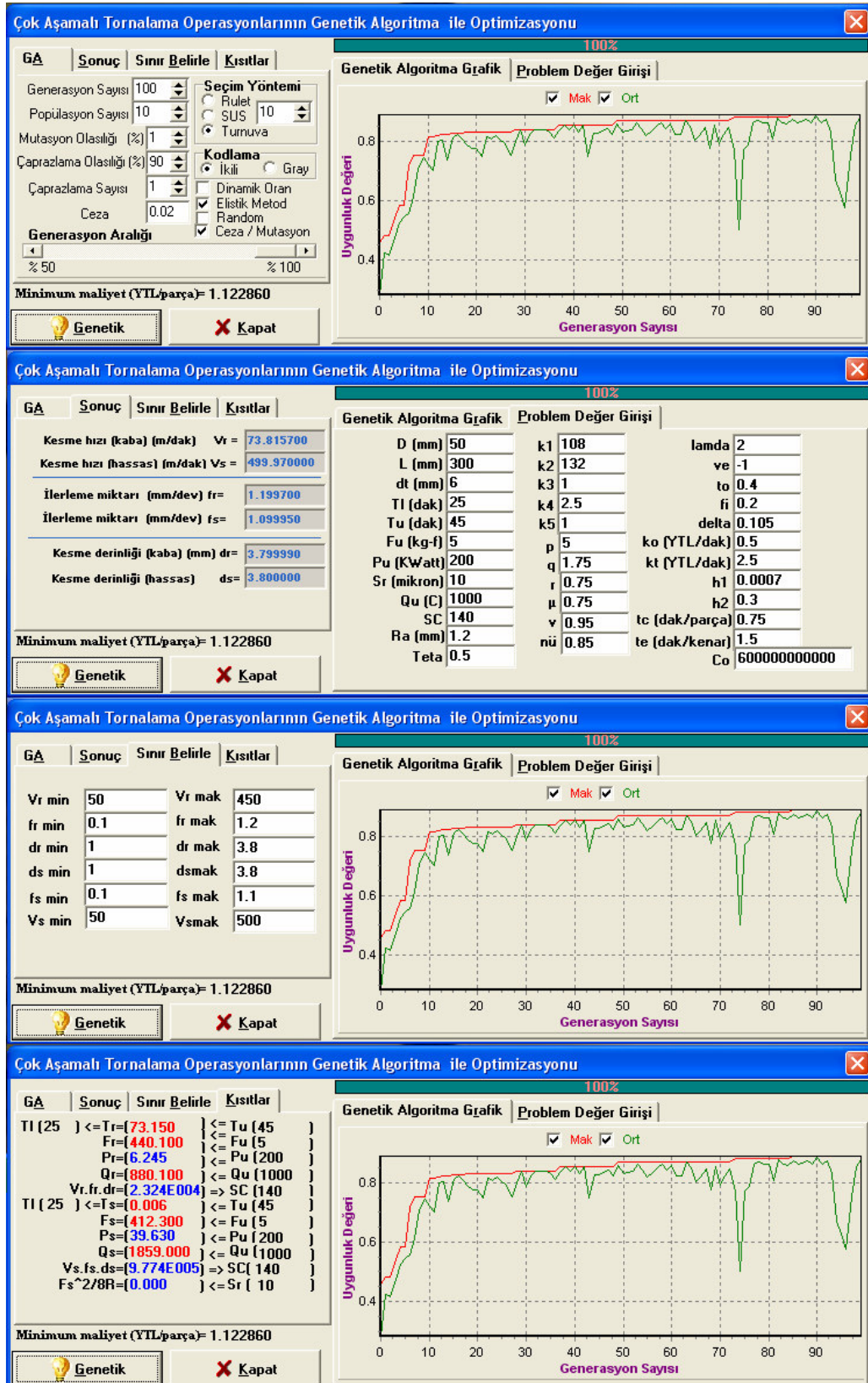
Şekil IV.32 Turnuva seçim yöntemi için parça başına maliyet değeri hesaplaması
