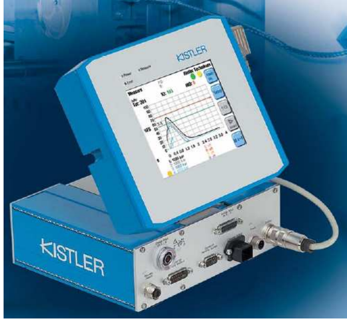
Şekil III-14 Kistler como tipi2869a amplifikatörü
