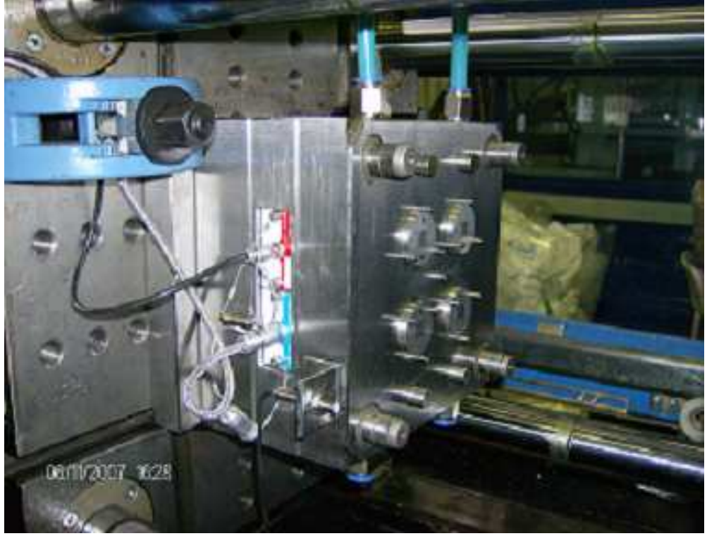
Şekil III-23 Deneş kalıbına basınç ve sıcaklık konektörlerinin yerleşimi
