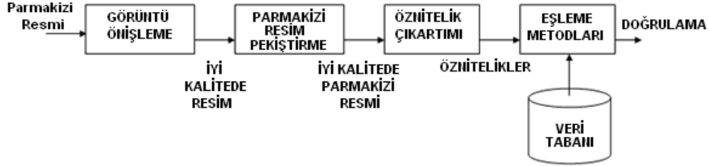
Şekil II.16 Bir parmakizi doğrulama sisteminin genel yapısı [13]
